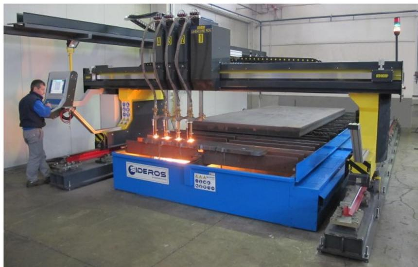
E' entrato in funzione un **nuovo pantografo** con 4 cannelli da taglio e con un **banco di lavoro di 2500 mm x 6000 mm**. La macchina sarà corredata di una unità di filtrazione ECO 9 a 9 cartucce **SIDEROS ENGINEERING**.
